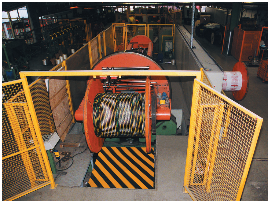
Mașină de produs cabluri, cu secțiuni de până la 4x185
