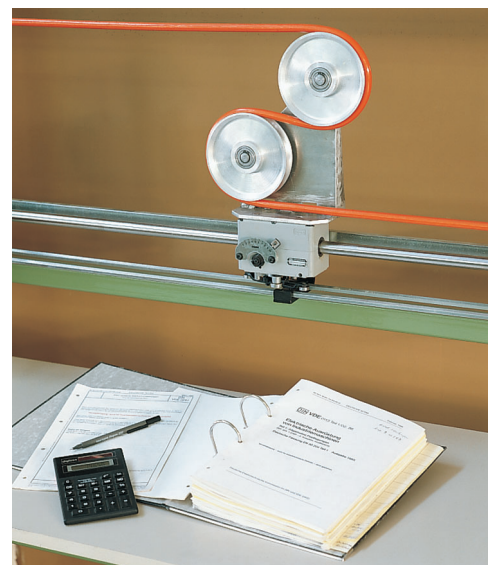
Mașină de testat cabluri în conformitate cu VDE 0472
